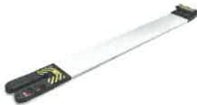
Bloccaggio anteriore e posteriore per barelle Spencer certificato EN-1789 ("10G") modello S-MAX. È il sistema di fissaggio per barelle certificato 10G, in conformità a quanto richiesto dalle norme tecniche EN 1865 e EN1789. Il gancio, nella parte anteriore è formato da leverismi che si chiudono al passaggio del perno anteriore della barella. Il gancio è realizzato in acciaio al carbonio verniciato e resiste a temperature di utilizzo che vanno dai -20 ai +60 °C. Dimensioni: 1790x190x80
