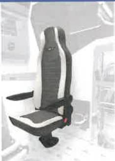
Sedile singolo contromarcia: sedile singolo contromarcia imbottito testato M1, in posizione centrale, rivestito in similpelle di varie colorazioni o bicolore o tinta unita, dotato di cinture di fissaggio a 3 punti, poggiatesta e due braccioli. Le dimensioni minime della seduta sono conformi a quanto stabilito nel D.M. 553 del 17/12/1987.
