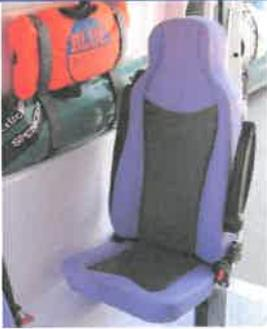
Sedile girevole frontemarcia su passaruota: Omologati EN1789-installazione nella parte posteriore della fiancata destra, su apposito supporto girevole a pavimento, di un sedile singolo frontemarcia omologato M1 con schienale reclinabile, rivestito in similpelle ignifuga in classe 1, dotato di cintura di sicurezza a 3 punti con arrotolatore, poggiatesta e braccioli. La seduta e' conforme a quanto stabilito nel D.M. 553 del 17/12/1987.
