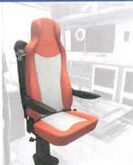
Sedile frontemarcia girevole: installazione in prossimita' del portellone laterale, su apposito supporto girevole a pavimento, di un sedile singolo, in similpelle, frontemarcia con schienale reclinabile, dotato di cintura di sicurezza a 3 punti con arrotolatore automatico, poggiatesta e braccioli.
