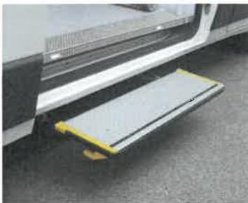
Gradino elettrico Stem GE380: fornitura ed installazione di un gradino elettrico laterale ultrasottile mod. Stem GE380. Gradino rientrante automatico a funzionamento elettrico, portata 300 kg. (Dim. 858 x 254 X 67,5 mm di spessore), pedana in estruso in lega leggera ad alta resistenza, illuminazione frontale e laterale.
