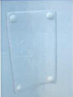
Pannelli ispezione luci: lungo i cantonali destro e sinistro vengono applicati due manufatti in vetroresina facili da rimuovere per una semplice ispezione delle luci posteriori originali Fiat.
