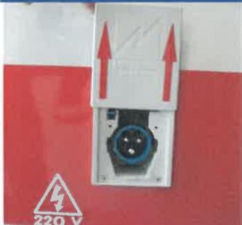
Presca esterna di ricarica 220V.: installazione sulla fiancata sinistra del veicolo, a lato della portiera del conducente, di una presa esterna tipo Camper per le utenze a 220V in fase di stazionamento. L'impianto è dotato d'interruttori salvavita di protezione in caso di cortocircuito + Inibitore avviamento.
