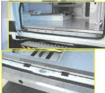
Rivestimenti: Rivestimento paraurti posteriore tramite l'installazione di un rivestimento in alluminio mandorlato antiscivolo. Installazione di un battitacco sulla porta laterale e sulla porta posteriore sempre in alluminio mandorlato antiscivolo, per ridurre l'usura del pavimento.
