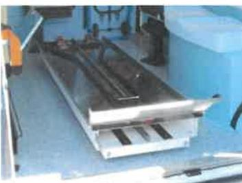
Piano traslabile con traslazione laterale: fornitura ed installazione di un supporto barella con sistema di spostamento laterale con blocco a pedale, scivolo ribaltabile per facilitare la salita della barella e vano singolo sottostante per il contenimento di una barella a cucchiaio o di una tavola spinale. Tale supporto, consente di portare il piano barella ad un'altezza superiore a 40cm. dal piano di calpestio, come previsto nel D.M.553 del17/12/1987.
