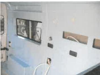
Parete Sinistra: la fiancata interna sinistra del veicolo viene costruita con due moduli: una cornice-vetro posteriore, un elemento di dimensioni analoghe sulla parte anteriore del comparto sanitario. I due elementi sono manufatti prestampati in vetroresina.
