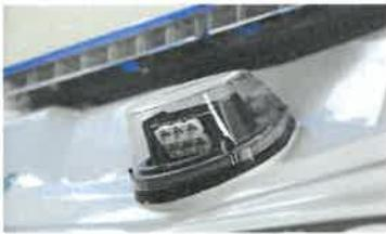
Faro di ricerca da 6 PowerLED, con forma ribassata ed aerodinamica, a brandeggio elettrico (movimento verticale 110°, orizzontale 360° no stop) telecomandato modello BL6 Omnilux provvisto di: Dispositivo automatico antiabbagliamento all'accensione e ritorno automatico allo spegnimento.
