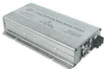
Caricabatteria doppio: installazione di un doppio alimentatore caricabatterie, con dispositivo termico di sicurezza. Con rete 220V esterna collegata, il sistema ricarica entrambe le batterie (motore e servizi) fino al raggiungimento di una soglia di 14,4V per poi garantire una corrente minima di mantenimento.
